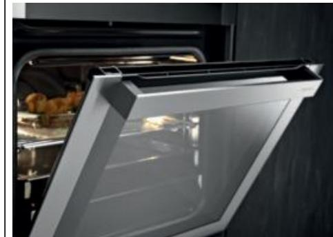
La porta è realizzata con 4 vetri termoriflettenti per garantire basse temperature esterne. È dotata di dispositivo automatico che ne blocca l'apertura all'avvio della funzione pirolisi. Il forno pirolitico dispone inoltre di una particolare guarnizione resistente alle alte temperature.
