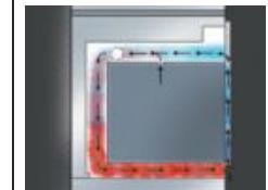
Mantiene le temperature esterne entro i limiti stabili dalle norme di sicurezza. All'accensione del forno entra in funzione, fino a dopo lo spegnimento, una ventola di ventilazione tangenziale che normalizza la temperatura producendo un flusso d'aria fredda.
